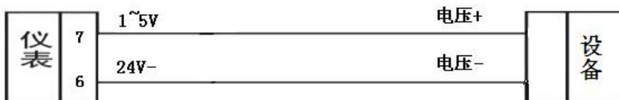
图2.6 1~5V模拟电压输出接线示意图
